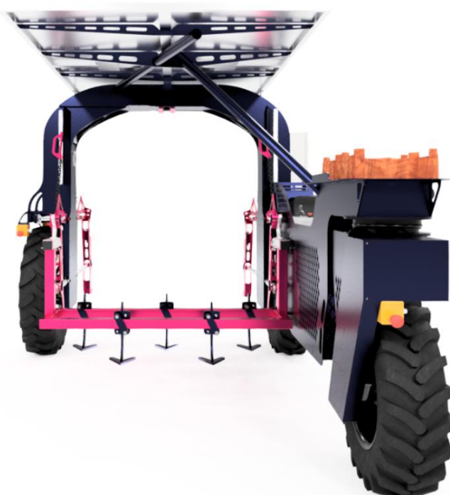
Module avec des éléments de binage inter-rangs sur le relevage central
